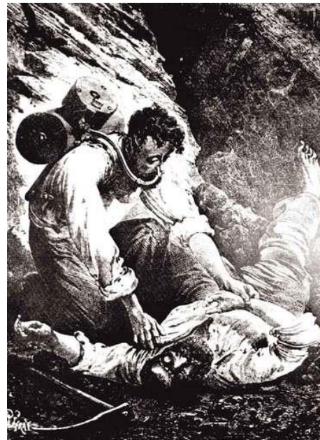
Isoleur Rouquayrol, utilisé comme appareil de sauvetage dans les mines
